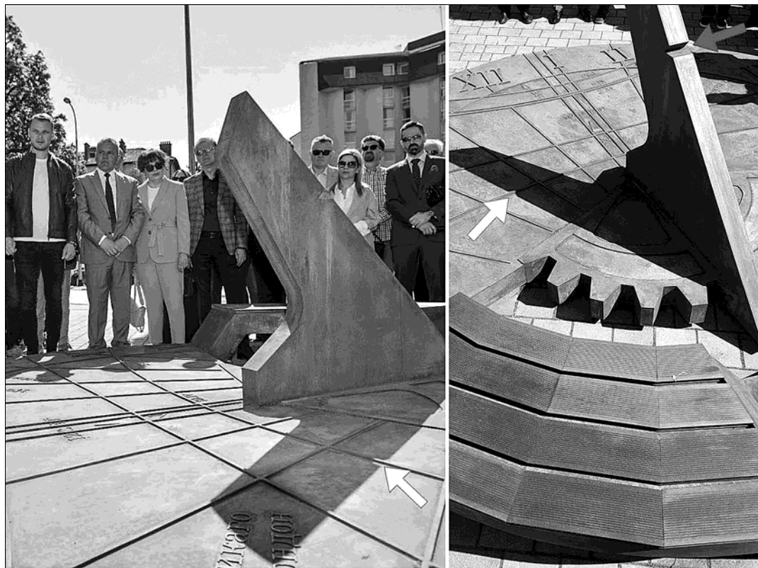
Слика 2. Провера: на дан откривања сунчаног сата, 22. априла 2023. године, урез у сенци кретао се тачно уздуж одговарајуће хиперболе.
